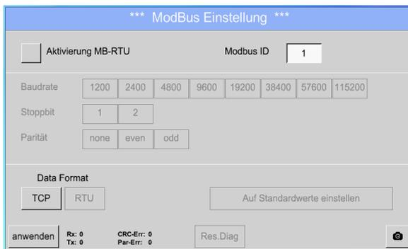
Aktivierung des RTU Modbus mittels setzen des „**Aktivierung MB-RTU**“ Knopfes
