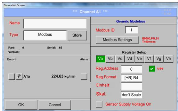
Durch drücken auf das Textfeld *Einheit* gelangen Sie in eine Liste mit den verfügbaren Einheiten
