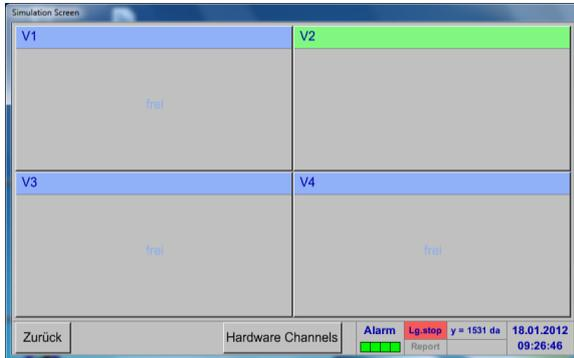
Nach Aktivierung des Knopfes „Virtual Channels“ im Sensor Einstellung Menü erscheint eine Übersicht der verfügbaren 4 Kanälen
