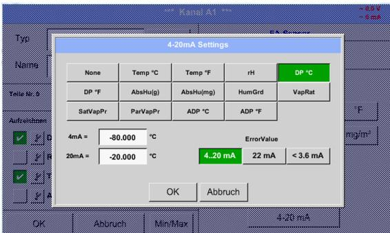
Dieses Menü erlaubt die Einstellung / Zuordnung des Messwertes und der Skalierung des Analogausganges.
