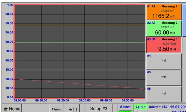
Trägt man im Setup kein y-Achsen-Skalierung ein, wird *min* auf 0, *max* auf 100 und *Raster* auf 10 gesetzt (Setup #3).
