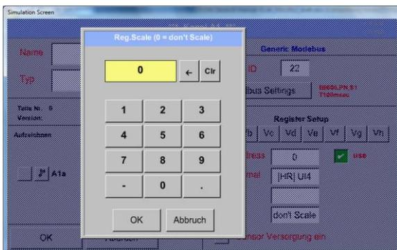
Die Verwendung dieses Faktors ermöglicht die Anpassung des Ausgabewertes um denselben.
