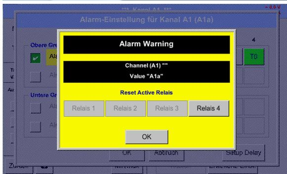
Bei Auftreten eines Alarm z.B. hier Alarm1 (gelb) von Kanal A1 wird eine Meldung eingeblendet.
