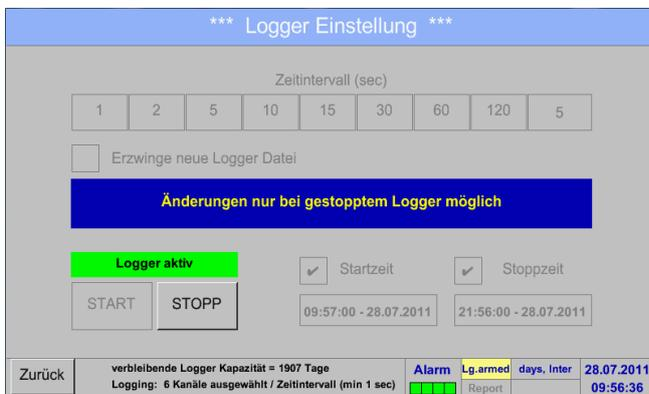
Nach der **Start**- bzw. **Stopzeit**-Aktivierung und den vorgenommenen Einstellung, wird der **Start**-Knopf gedrückt und der Datenlogger steht auf **Lg.run**.
