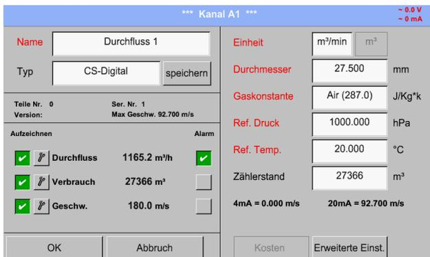
Die rot beschrifteten Textfelder zeigen an, dass verschiedene Werte wie z. B. der *Durchmesser* und der *Name* geändert oder hinzugefügt wurden.
