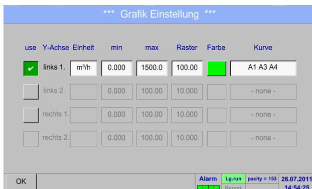
6. Im *Kurve*-Textfeld wird angezeigt, auf welchem Kanal die Messdaten aufgezeichnet wurden, und es ist ersichtlich, wie viele Aufnahmen auf einer y-Achse dargestellt werden.
