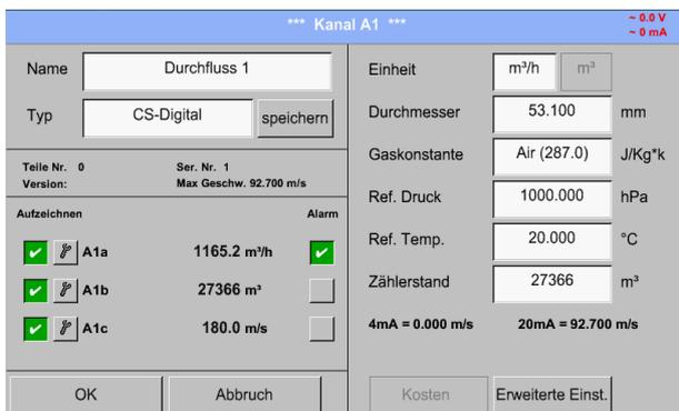
Das DS 500 erkennt, ob es sich bei dem angeschlossenen Sensor um ein Durchfluss- oder Taupunkt-Sensor von **CS Instruments** handelt und stellt den **CS-Digital** Subtyp automatisch richtig ein.
