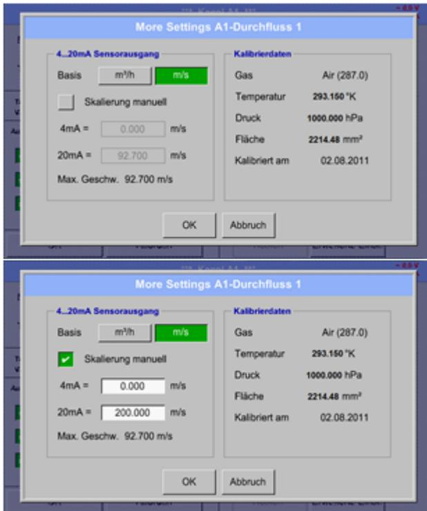
In *Erweiterte Einstellungen* kann man festlegen, ob der 4-20mA-Analogausgang des Sensors auf der Durchflussmenge oder der Geschwindigkeit basieren soll.
