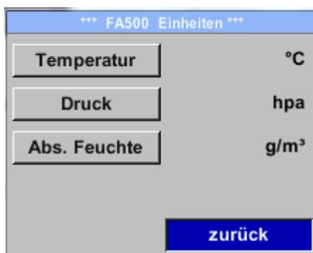
Um Änderungen der Einheit für den jeweiligen Messwert vorzunehmen muss mittels Taste „ $\Delta$ “ das Tastenfeld des Messwertes angewählt werden und mit Taste „**OK**“ aktiviert werden.
