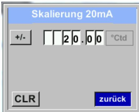
„Skalierung 4mA“ und „Skalierung 20mA“ erlaubt die gewünschte Skalierung zu definieren.
