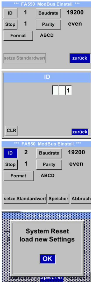
Um Änderungen, z.B. der Sensor ID, vorzunehmen, wird mittels Taste „ $\Delta$ “ das Feld „ID“ selektiert und anschließend mit Taste „OK“ ausgewählt.
