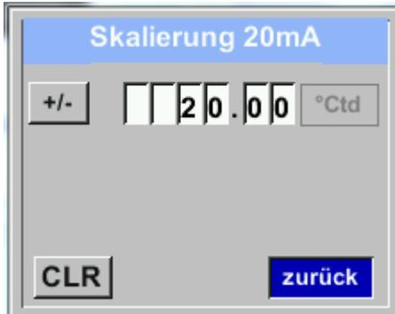
„Skalierung 4mA“ und „Skalierung 20mA“ erlaubt die gewünschte Skalierung zu definieren.
