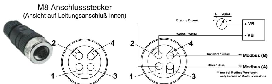
**Hinweis:** Der Sensor ist im spannungslosen Zustand anzuschließen
