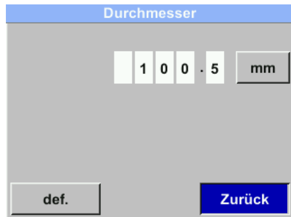
Abbildung 17: Rohrinnendurchmesser anpassen (Beispiel)
