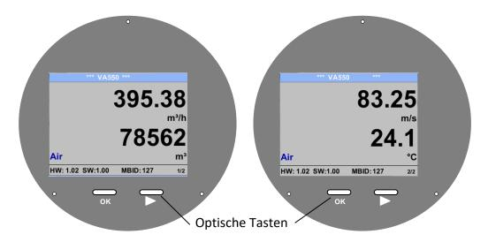
Die Auswahl der einzelnen Menüpunkte erfolgt durch die Taste ">" und Bestätigung durch Taste "OK"
