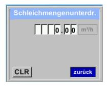
Die Schleichmengenunterdrückung kommt in Anwendung um Verbrauchswerte unterhalb des definierten "LowFlow Cut off" Wertes als 0 m³/h anzuzeigen und auch nicht zum Verbrauchzählerstand zu addieren.
