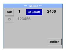
Mittels ">" die Taste "Baudrate" anwählen und anschließend mit Taste "*OK*" auswählen.
