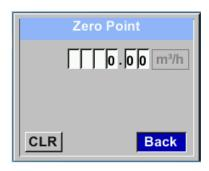
Zeigt der Sensor im eingebauten Zustand ohne Durchfluss bereits einen Durchflusswert von > 0 m³/h kann man hier den Nullpunkt der Kennlinie setzen.
