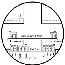
Version mit Optionboard 2x Analogausgang 4...20mA galvanisch getrennt.
