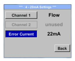
Hiermit wird festgelegt was im Fehlerfall am Analogausgang ausgegeben wird.
