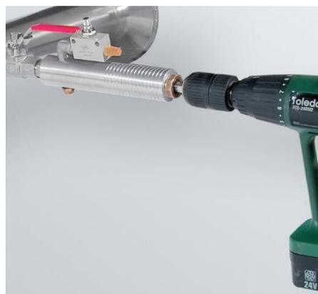
Falls die Anlage nicht heruntergefahren werden kann, d.h. drucklos gestellt werden kann, kann mit Verwendung der CS-Bohrvorrichtung (Best.-Nr. 0530 1108) unter Druck gebohrt werden.
