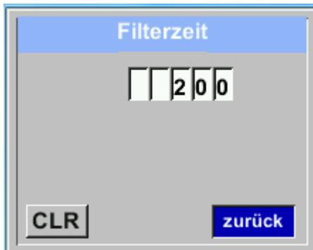
Unter dem Punkt „**Filterzeit**“ kann eine Dämpfung festgelegt werden. Eingabe Werte von 0 -10000 in [ms] sind möglich.
