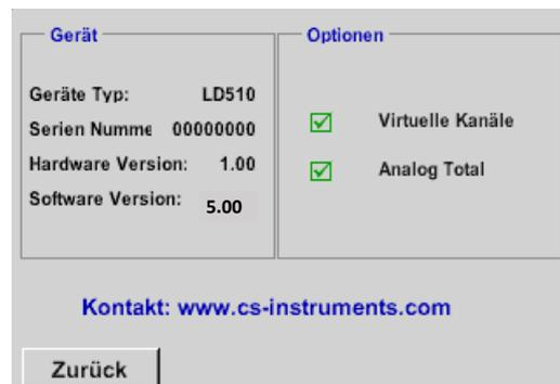
Im Beispiel ist die Hardware 1.00 und somit nicht intelligent. → In diesem Fall kann CS INSTRUMENTS die Hauptplatine austauschen.
