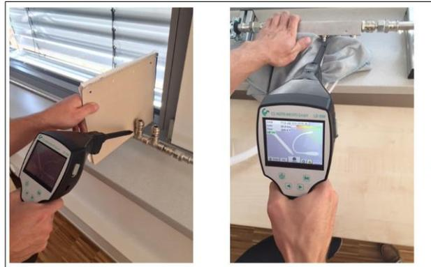
**Überlagerung von Leckagen:** Sollten Leckagen räumlich nah beieinander sein, überlagert sich der emittierte Ultraschall. Hier wird empfohlen, die Leckagen mit einem „Tuch abzudichten“. Speziell bei Quantifizierung der
