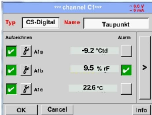
DP 510 表明, 如果连接一个CS Instruments的流量或露点传感器, 仪器可以自动校正为CS-数字型传感器设置
