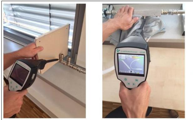
**漏点的叠加：**如果泄漏点相互靠近，则发射的超声波会重叠。在这种情况下，建议用布封住泄漏点。这极大地提高了测量的准确性，特别是对泄漏的量化。同时，应在靠近部件的地方进行测量。
