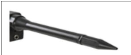
拉直管只允许极少的超声波在超声波换能器的方向通过，从而可以非常精确地定位泄漏点。
