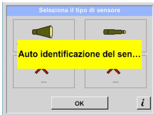
Se il rilevamento automatico del sensore è attivo, la selezione libera del tipo di sensore è bloccata. Il presupposto è una scheda madre intelligente dell'LD 500 e un sensore intelligente (ad es. tromba acustica).
