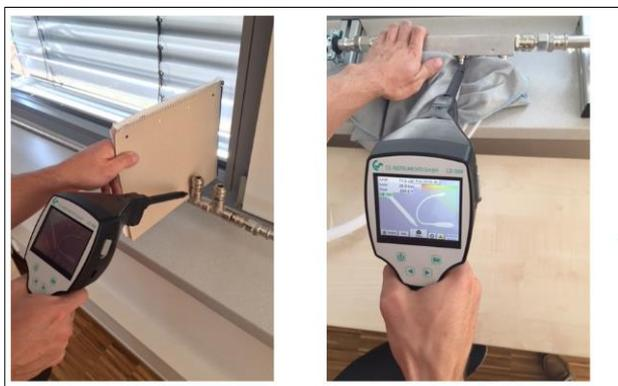
**Sovrapposizione di perdite:** Se le perdite sono vicine tra loro, gli ultrasuoni emessi si sovrappongono. In questo caso, si consiglia di sigillare le perdite con un panno. Questo aumenta enormemente l'accuratezza della misura, soprattutto per la quantificazione della perdita. Allo stesso tempo, le misure devono essere effettuate in prossimità dei componenti.
