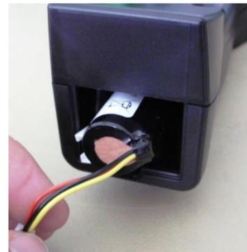
*Rimozione del coperchio della batteria
