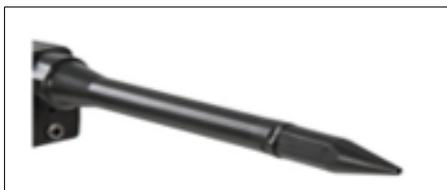
Il tubo di raddrizzamento permette di far passare solo pochissime onde ultrasoniche in direzione del trasduttore a ultrasuoni, consentendo di localizzare con estrema precisione le perdite.
