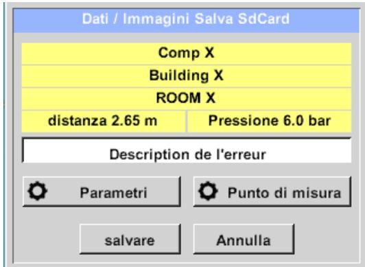
Successivamente è possibile controllare i parametri (pressione e distanza) e definire con precisione il luogo di misurazione con azienda, edificio e località. È inoltre possibile inserire una breve descrizione dell'errore (max. 32 caratteri).
