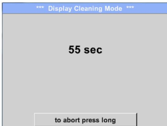
Denna funktion kan användas för rengöring av pekskärmen under löpande mätningar.
