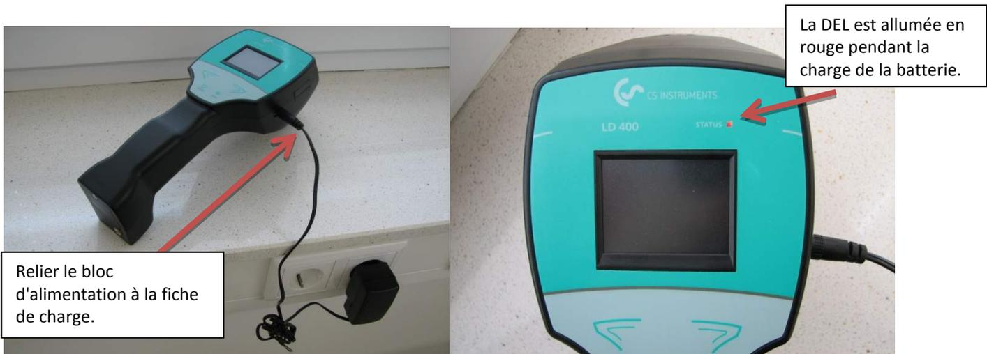
Le LD400 vérifie l'état de charge de la batterie et démarre le cas échéant automatiquement la charge. Les scénarios suivants sont possibles :
