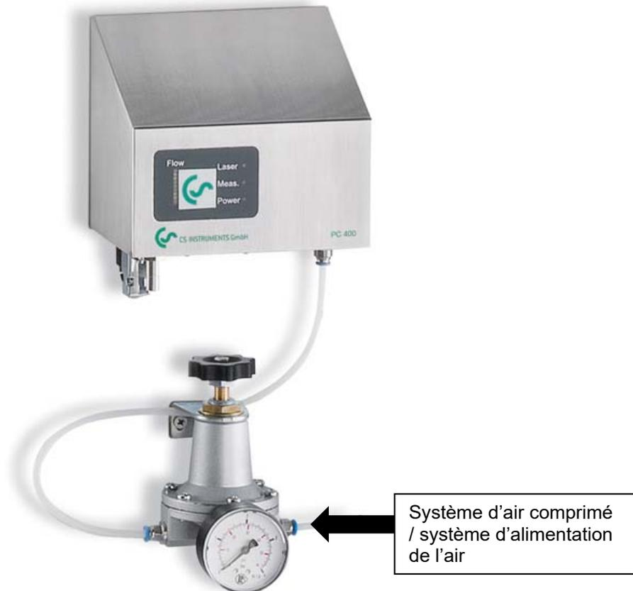
**Important : La pression sur le compteur de particules PC 400 n'est pas autorisée à dépasser 1,6 bar de surpression. La pression doit être réduite en conséquence par le contrôleur de pression fournie.**
