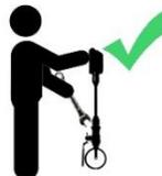
**Attention :** L'alignement du capteur ne doit pas être modifié lors du serrage du fil de raccordement et de la douille d'adaptation. Dans ce cas, vérifiez à nouveau la profondeur d'immersion et l'alignement et corrigez-le si nécessaire. L'écart angulaire ne doit pas être supérieur à  $\pm 2^\circ$  par rapport à la position idéale, sinon la précision de la mesure diminue.
