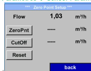
En pressant „Reset“, les réglages „ZeroPnt“ et „CutOff“ sont remis à zéro.
