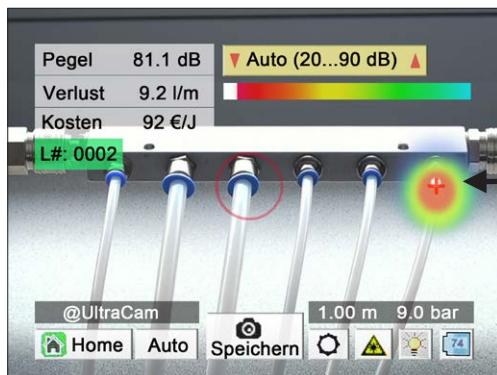
UltraCam LD 500/510, ultrasonik görüntüyü oluşturmak ve görselleştirmek için 30 MEMS mikrofonlarını kullanır. Ayrıca cihaz, insan kulağının duyamadığı ultrasonik sesi işitlebilir hale getirir
