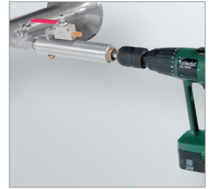
CS delme tertibatı ile basınç altında delme
