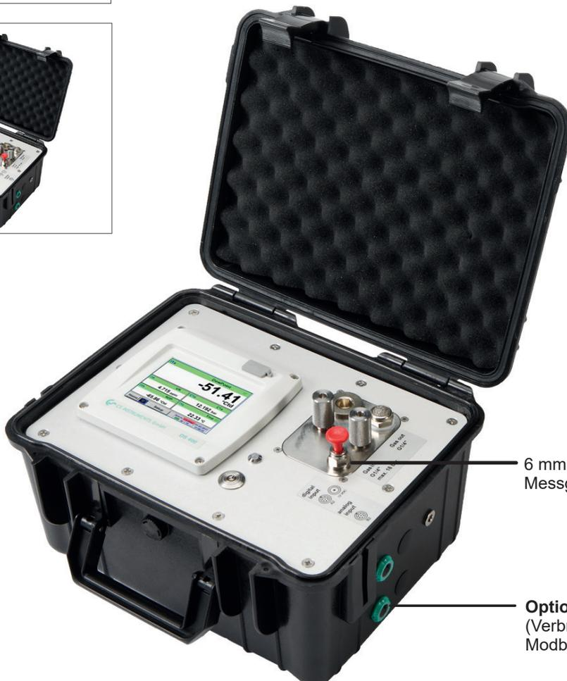
6 mm Steckanschluss zur Messgas-/ Druckluft Zuführung
