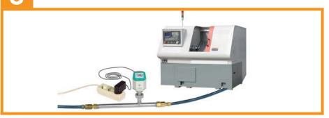
Mit Schnellkupplungen lässt sich der Verbauchszähler schnell in den Zuleitungsschlauch vor einer Maschine integrieren. Bei Stillstand der Maschine kann die Leckrate ermittelt werden, bei laufender Maschine deren Momentanverbrauch. Die Stromversorgung erfolgt über die Steckdose mit dem Steckernetzteil. Zur Datenaufzeichnung über einen längeren Zeitraum empfiehlt sich der Einsatz des DS 400 mobil.
