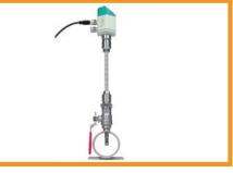
Für Rohrdurchmesser von 2" bis DN 300 steht der bewährte Verbrauchssensor VA 400 zur Verfügung. Sein konstruktiv durchdachter Aufbau ermöglicht den Einbau auch unter Druck in Rohre mit Nennweiten DN 300. Der Einbau erfolgt durch einen handelsüberlichen 1/2" Kugelhahn.
