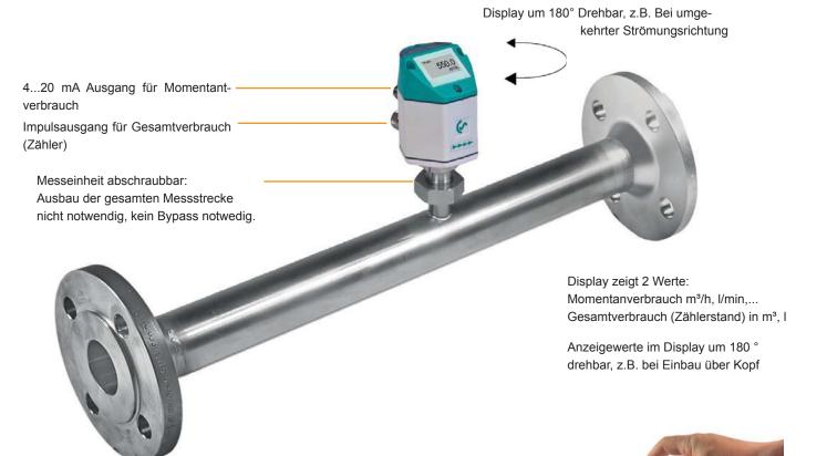
Einfacher Einbau in die vorhandene Rohrleitung durch integrierte Messstrecke und Vorschweißflansch (nach EN 1092-1 PN 40) Hohe Messgenauigkeit durch definierte Messstrecke (Ein- und Auslaufstrecke).
