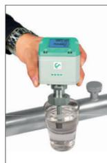
Der Sensor kann entfernt und gereinigt werden
