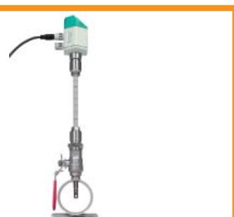
Senzorul VA 400 pentru masurarea consumului este disponibil pentru conducte de la DN 50 la DN 300. Designul sofisticat permite instalarea in conducte cu diametrul nominal pana la DN 300, chiar si sub presiune. Instalarea se face cu ajutorul unei valve standard cu bila, de dimensiune 1/2".
