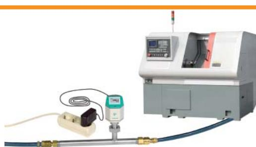
Folosind o cupla rapida, contorul de aer comprimat poate fi integrat usor in circuitul de alimentare al unei masini. Pe durata opririi utilajului este posibila determinarea pierderilor, consumul actual fiind determinat in timpul functionarii acestuia. Alimentarea cu tensiune se face utilizand un alimentator de retea. Pentru inregistrarea datelor pe o perioada lunga de timp, recomandam utilizarea unui dispozitiv DS 400 mobile, destinat analizei aerului comprimat.
