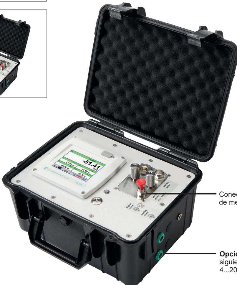
Conector de 6 mm para la alimentación de gas de medición/aire comprimido
