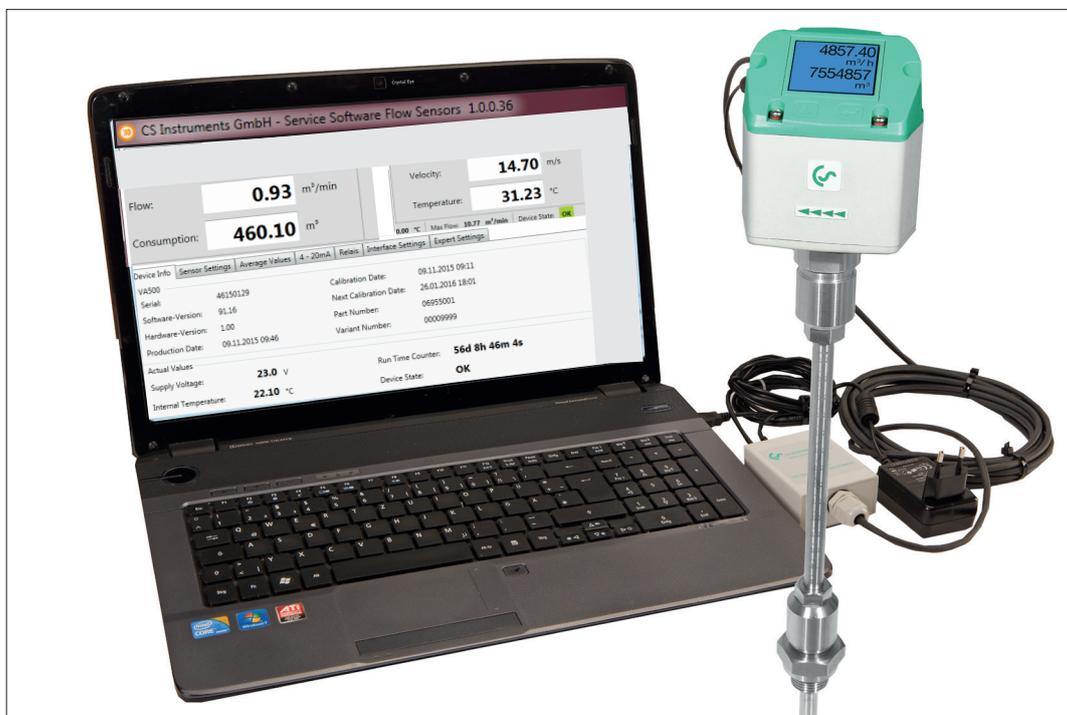
Los caudalímetros VA5xx se pueden conectar en el PC y se pueden realizar los siguientes ajustes con el programa CS Service Software:
