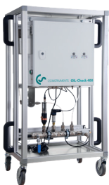
Misura della qualità dell'aria compressa
