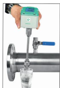
Il sensore può essere rimosso durante il funzionamento e pulito se necessario.
