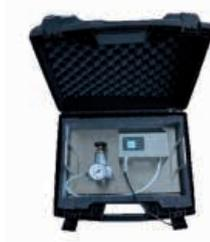
Medición de la calidad del aire comprimido
