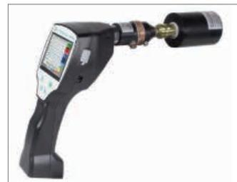
La caja de secado protege el sensor y permite un tiempo de adaptación corto
