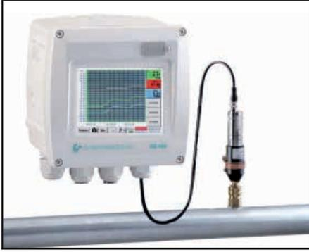
El sensor de punto de rocío DS 400 consta del vídeo registrador DS 400 y el sensor de punto de rocío FA 510 incl. la cámara de medición para medir el punto de rocío a presión del aire comprimido y de gases hasta 16/50/350 bar.
