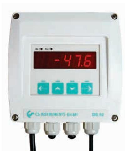
Con l'indicatore di processo LED DS 52 in elegante custodia. DS 52 dispone di 2 contatti allarme privi di potenziale (contatti in scambio) con carico max. 230 V CA, 3 A. Valori di soglia sono configurabili tramite tastiera.
