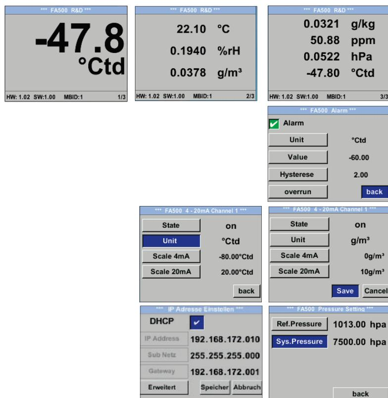
Il display integrato mostra il punto di rugiada con caratteri di grosse dimensioni e altri parametri su 2 schermate del display. Con il tasto a freccia si può passare da un display all'altro.
