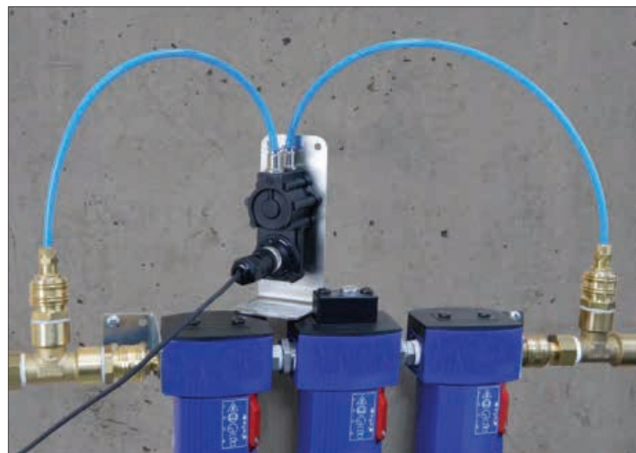
使用两根 PE 软管进行差压测量的典型安装位置为滤芯前后方。
