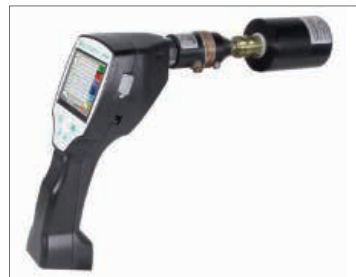
Trockenbehälter sorgt für Sensorschutz und eine schnelle Angleichzeit
