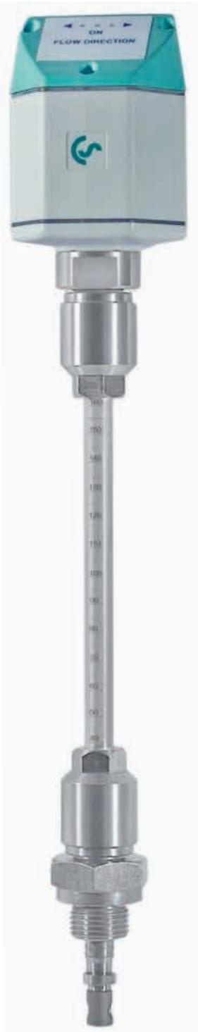
Le nouveau commutateur de sens d'écoulement thermique VA 409 indique localement la direction du flux. Il sert à déterminer le sens d'écoulement de l'air comprimé et des gaz, en particulier dans des conduites en circuits fermés ou les réseaux bidirectionnels.
