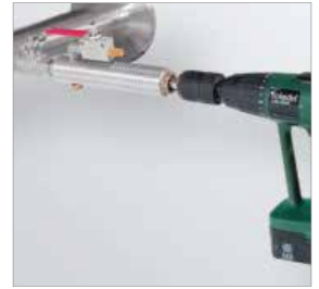
CS delme tertibatı ile basınç altında delme
